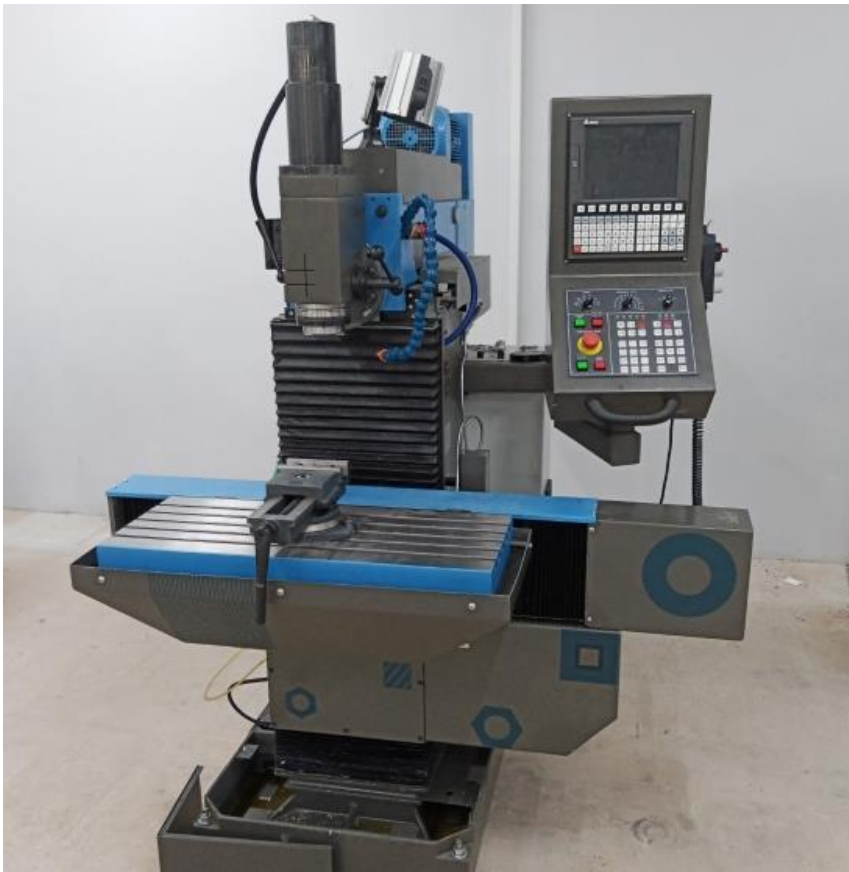
Рисунок 3: Станок фрезерный с ЧПУ 6Л1725 в цехе №49 пом.132/4 зд.100
