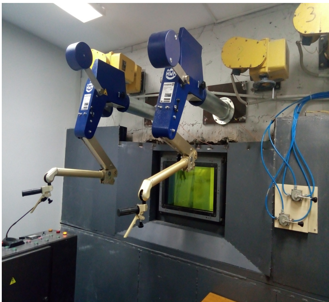
Рисунок 15. РТЛ. Камера защитная для хранения и перегрузки ЗРИ
